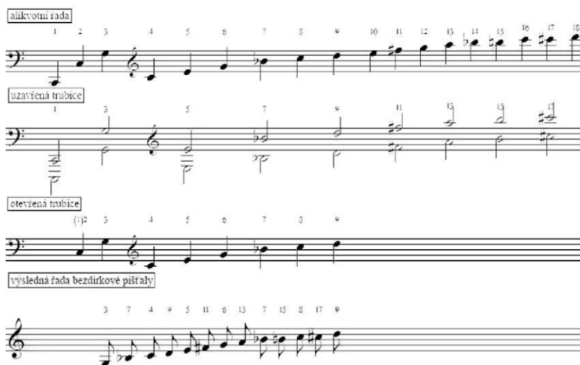
■ Princip vzniku tónové řady aliquotní flétny / obr. 1
