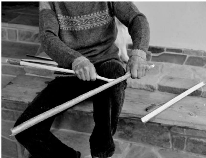
■ Vytrhávání jádra lískového prutu / obr. 3 (Foto V. Bjaček, 2013)
