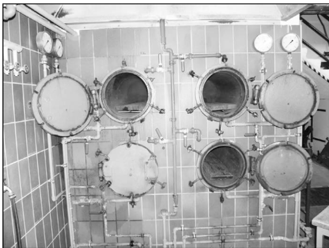
Současná technika – napařovací válce v továrně Thonet Vienna ve Friedbergu Fotoarchiv autora
