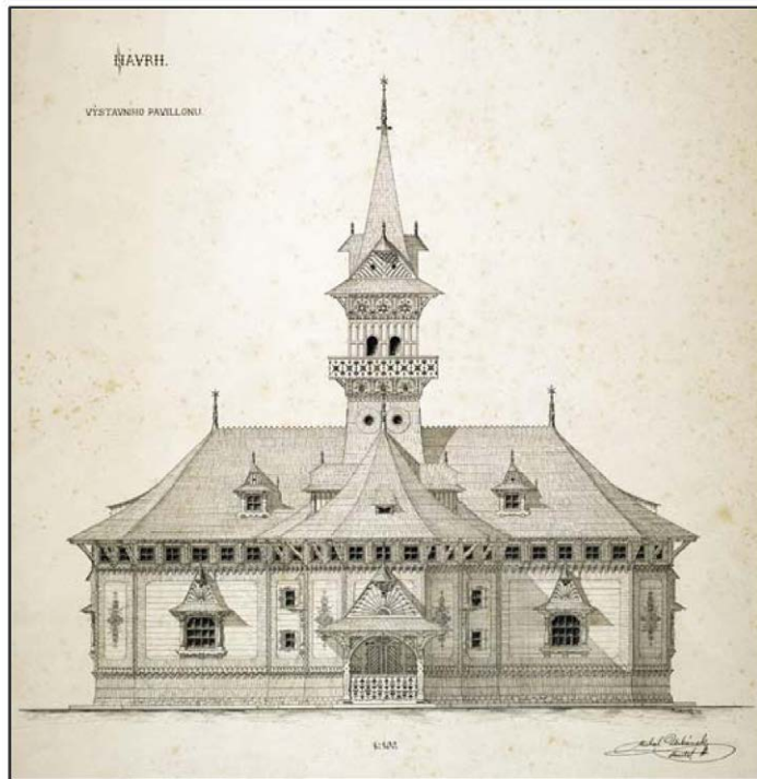
Návrh výstavního pavilonu z roku 1893 (SNA v Bratislavě, FPDJ) Čelní pohled, měřítko 1:100. Tuš, 67x50 cm, signováno a datováno vpravo dole pod kresbou: Jurkovič 93, sign. vpravo dole: Michal Urbánek / stavitel Předlohou pro pavilon byl dřevěný karlovický kostel z 18. století, který D. Jurkovič zaměřil rovněž v roce 1893.
