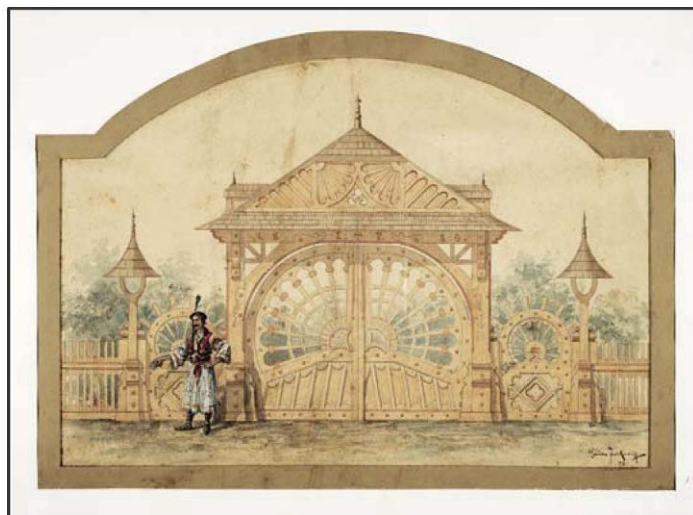
Návrh výstavního pavilonu z roku 1893 (SNA v Bratislavě, FPDJ) Čelní pohled, měřítko 1:100. Tuš, 67x50 cm, signováno a datováno vpravo dole pod kresbou: Jurkovič 93, sign. vpravo dole: Michal Urbánek / stavitel Předlohou pro pavilon byl dřevěný karlovický kostel z 18. století, který D. Jurkovič zaměřil rovněž v roce 1893.
