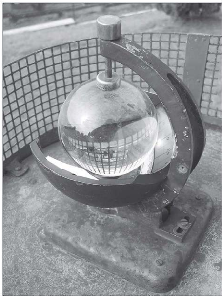
Heliografem byla do roku 2005 měřena délka slunečního svitu Foto E. Březina
