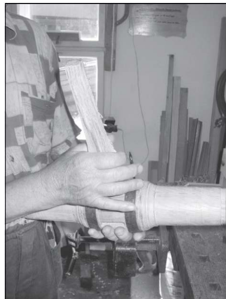
Zasazení paprsků („špic“) do náboje – přesně vyměřený sklon a délka špice
